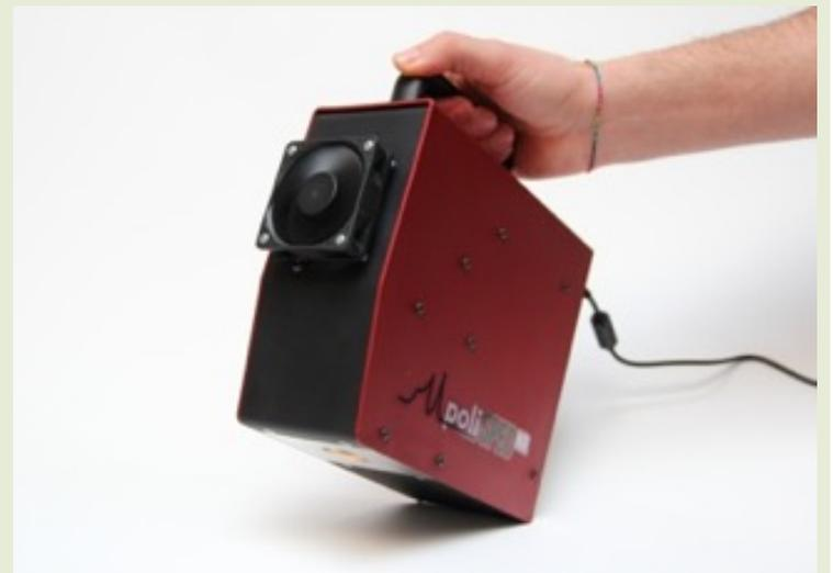
consente di realizzare analisi di foraggi e di miscele unifeed direttamente in azienda, ottenendo così un risultato immediato da inserire nel programma di razionamento.
